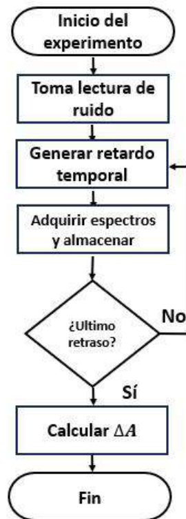
Figura 3.13: Diagrama de adquisición de datos para calcular la señal de TA.
