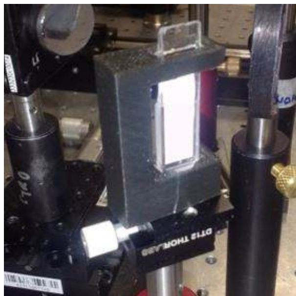
Figura 3.17: Fotografía de la base trasladora para el porta-muestras.
