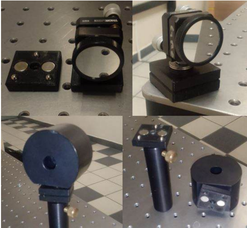
Figura 3.15: Fotografías de las monturas magnéticas cinemáticas empleadas en espejos abatibles y trampas de luz requeridas en el espectrómetro de TA.
