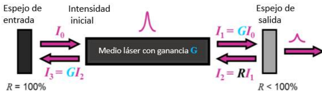
Figura 2.6: Cavidad láser: la cavidad está compuesta por un medio de ganancia y dos espejos, la intensidad aumenta cada vez que el haz hace un viaje de ida y vuelta I_3 > I_0 , produciendo un haz intenso a través del espejo de salida [5].
