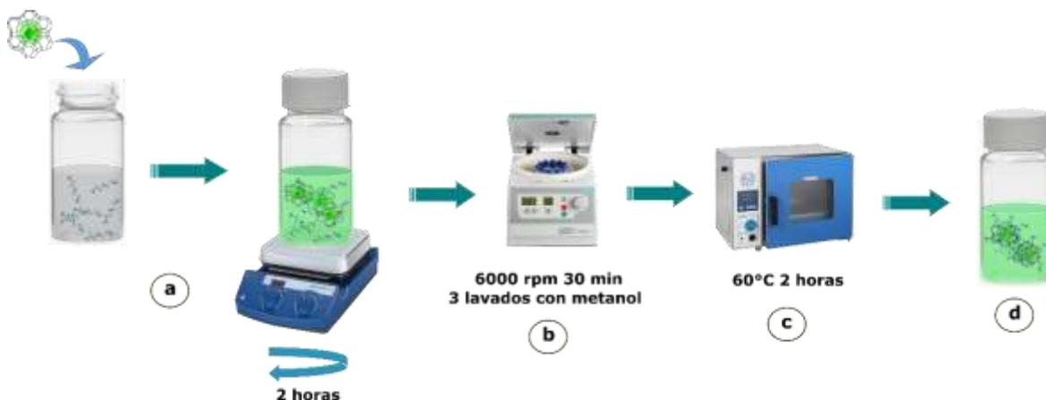
**Figura 2.2** Esquema de la metodología utilizada para la impregnación de las aminas a las zeolitas con clústeres luminiscentes de plata.
