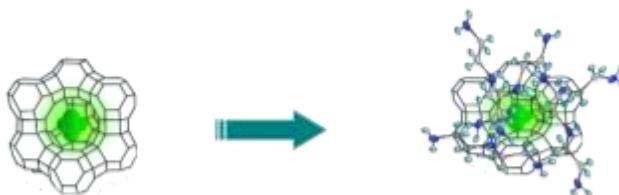
Para la funcionalización se utilizó el método de impregnación húmeda, el cual une las aminas a los poros y superficie de la zeolita mediante atracciones electrostáticas.
