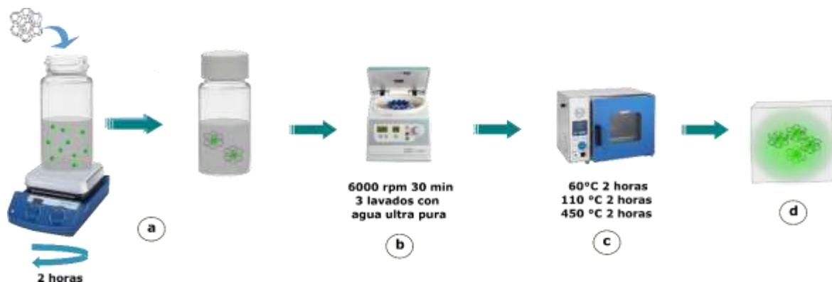
**Figura 2.1.** Esquema de la metodología utilizada para la síntesis de los clústeres luminiscentes de plata.
