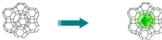
Se sintetizaron clústeres luminiscentes de plata  $Ag_6$  en faujasita X (FAUX) utilizando una metodología basada en síntesis reportadas anteriormente.<sup>45</sup> Ver **Figura 2.1.**
