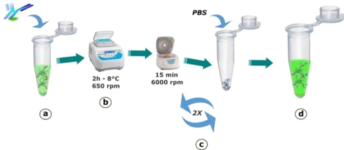
**Figura 2.4** Diagrama de la metodología utilizada para la unión de IgG-FITC y la medición de su emisión como herramienta de doble chequeo.
