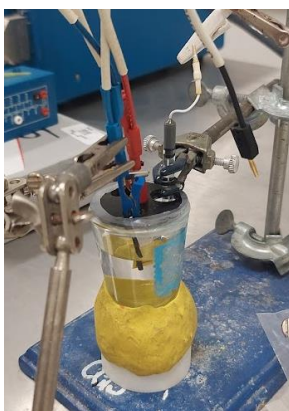
Figura 2.2 Sistema de tres electrodos para realizar experimentos de electroquímica. Los materiales sintetizados se usaron para crear electrodos de trabajo, Ag/AgCl como electrodo de referencia y platino (Pt) como contraelectrodo.
