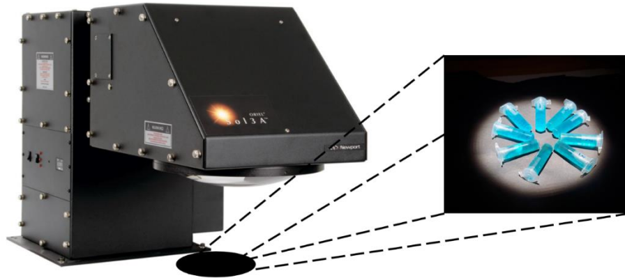
Figura 2.5 Configuración experimental para la degradación del colorante de azul de metileno usando simulador solar como fuente de luz.
