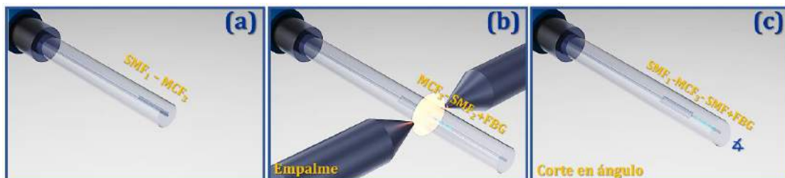
Figura 36. Proceso de fabricación del DFOS híbrido en reflexión: (a) Dispositivo en punta basado en una MCF 3 , (b) empalme del dispositivo en punta con una FBG inscrita en una SMF, y (c) dispositivo final en reflexión.
