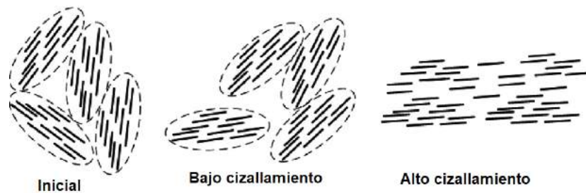
Figura 2.13: Representación esquemática de la teoría de dominios mesoscópicos de cristales bajo fuerzas cizallantes. Tomado de [12].
