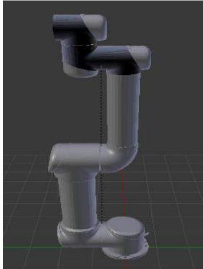
Figura 34. Ensamble eslabón 4 con eslabón 5.
