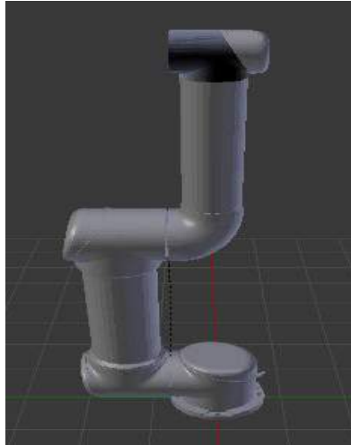
Figura 32. Ensamble eslabón 2 con eslabón 3.
