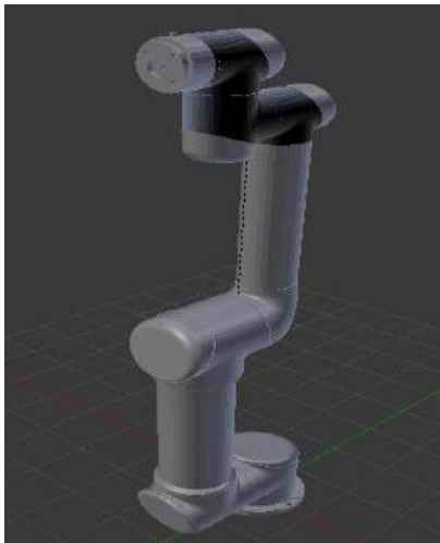
Figura 35. Ensamble eslabón 5 con brida para herramienta.
