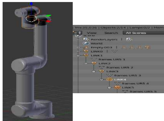
Figura 40. Emparentar eslabón 5 con eslabón 4.
