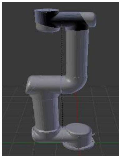
Figura 33. Ensamble eslabón 3 con eslabón 4.
