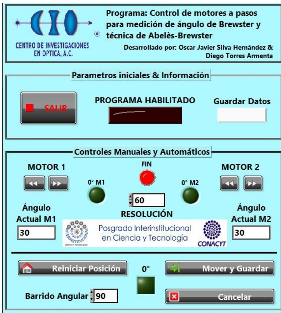
Figura 3.39. Panel frontal del sistema realizado en LabVIEW.
