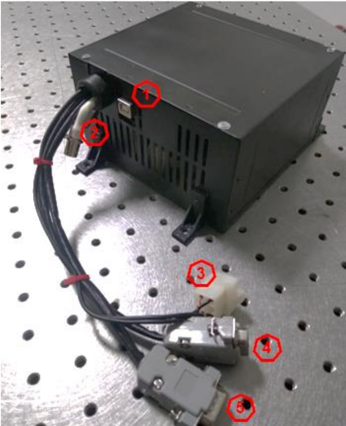
Figura 4.6. Fuente de poder con electrónica de potencia y de control.
