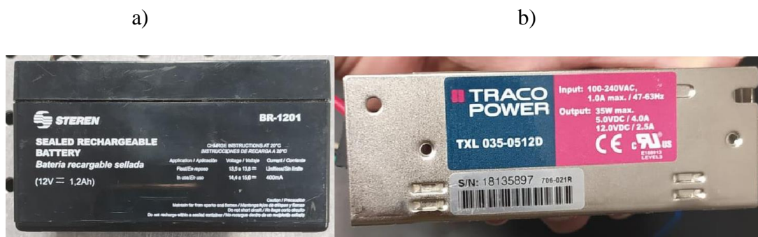
Figura 3.25 Sistema de carga, a) Batería recargable, b) Fuente de alimentación TXL 035-0512D
