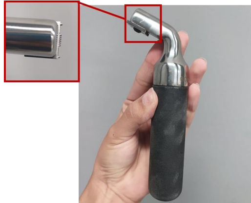
Figura 3.14 Cortador de trama cruzada, acercamiento a navaja
