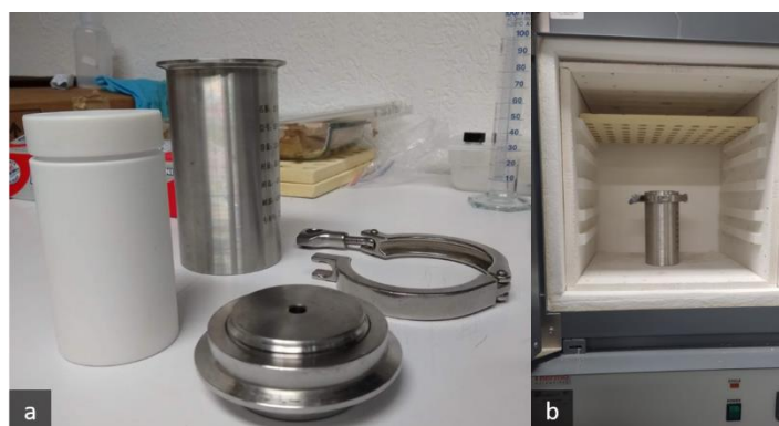
Figura 3.4 Esquema del sistema de autoclave que se utilizó para el tratamiento solvotermal. a) Componentes de la autoclave y b) autoclave realizando el tratamiento térmico.
