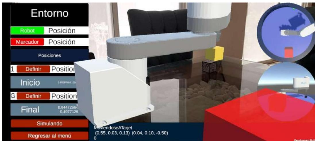
Figura 4.9: Control del robot virtual por medio de los marcadores de realidad aumentada
