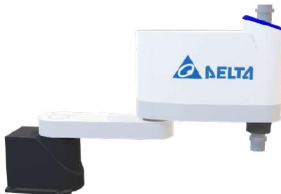
Figura 3.3: Modelo 3D del Robot SCARA Delta DRS60L
