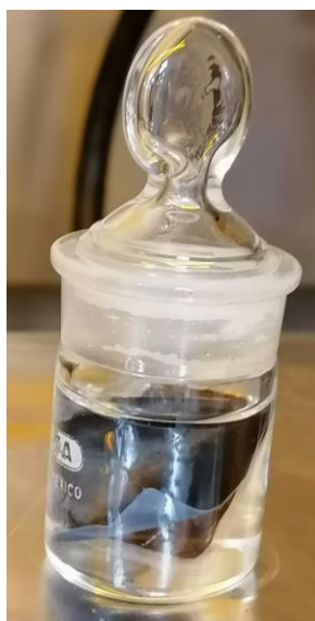
Fig. 3.6. Imagen del electrodo en proceso de reducción con hidracina.
