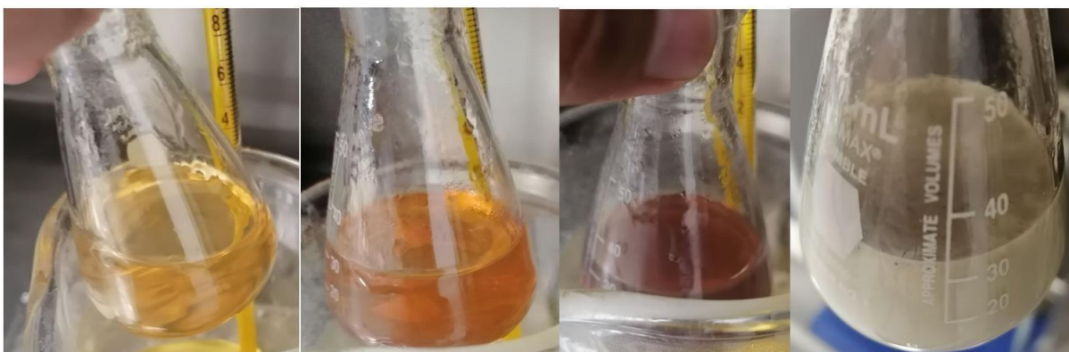
Figura 3.1. Proceso de síntesis de AgNWs. a) 30 minutos, b) 1 hora, c) 1.5 horas y d) 2 horas.
