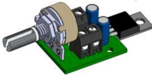
Figura 3.3. Circuito regulador para diodo láser: a) Diagrama esquemático, b) Vista inferior de circuito impreso y renders en 3D c) vista superior y d) vista isométrica.
