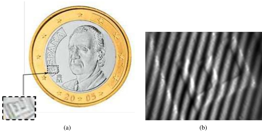
Figura 4.31: a) Objeto a medir, b) objeto con las franjas proyectadas.
