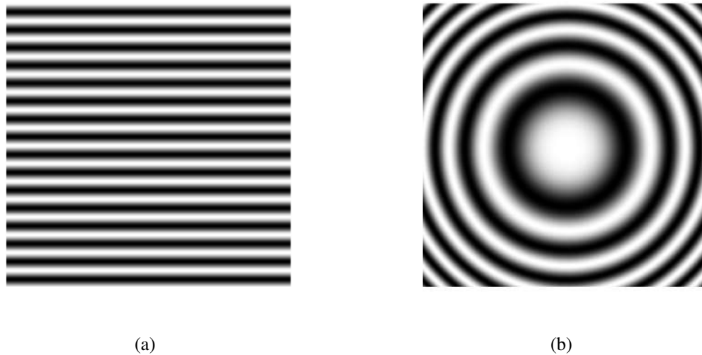
Figura 3.1: Simulación de un interferograma: (a) franjas abiertas, (b) franjas cerradas.
