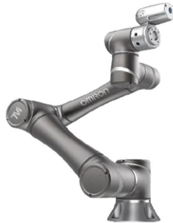
Figura 2.7: Robot colaborativo de seis grados de libertad, modelo TM5-900 [31].
