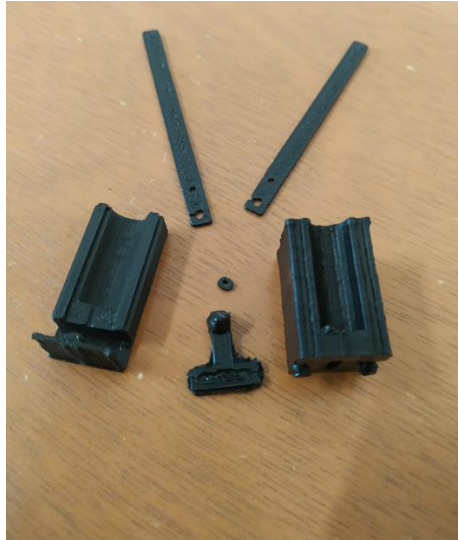
Figura 3.6. Piezas impresas en 3D material PLA
