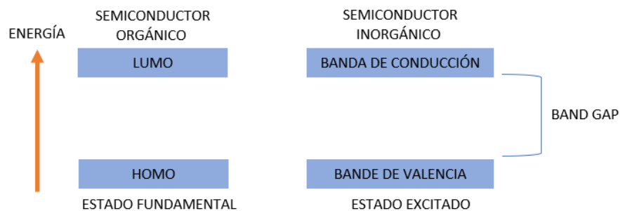
Figura 2.3: Esquema de equivalencia energética entre el semiconductor orgánico e inorgánico [26].
