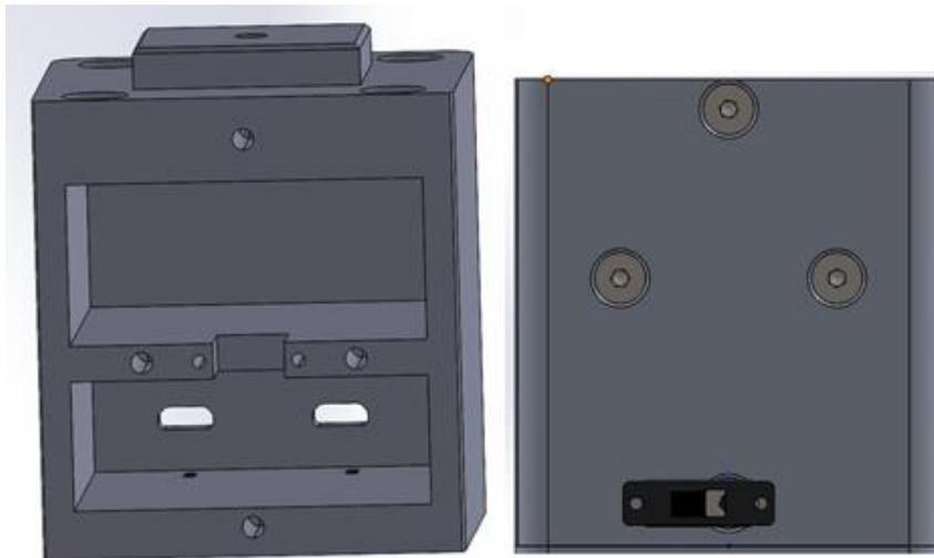
*Fig. 3.2.4.- Diseño de housing para componentes electrónicos*
