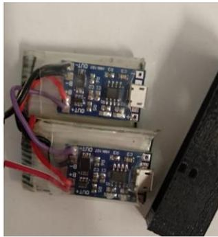
*Fig. 3.2.5.- Baterías Lipo con módulos cargadores*
