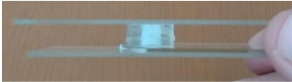
*Fig. 3.5.3. Arreglo final para análisis de líquidos*
