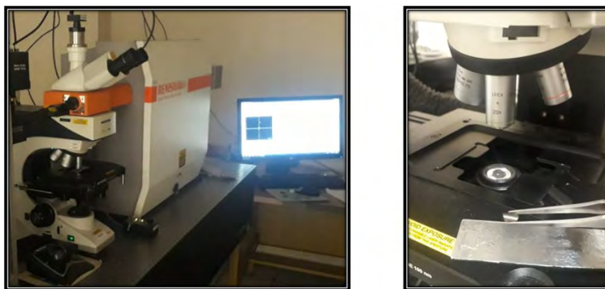
Figura 8: Fotografía del espectrómetro Renishaw, y microscopio donde se soportan las muestras.
