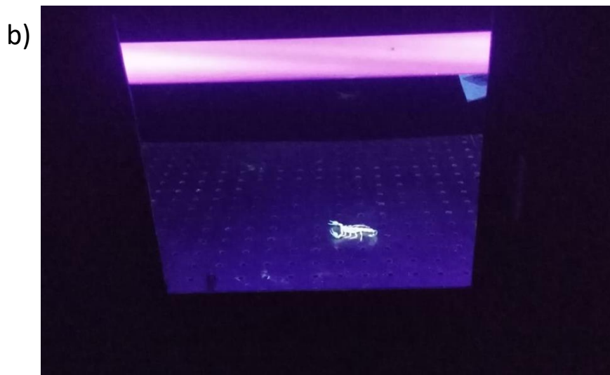
Fig. 2.2 a) Representación esquemática de la cámara de iluminación. En esta cámara, el alacrán se aísla de la luz exterior, se ilumina con luz ultravioleta o blanca y luego se fotografía. b) Imagen del interior de la cámara con un espécimen C. infamatus bajo iluminación ultravioleta.
