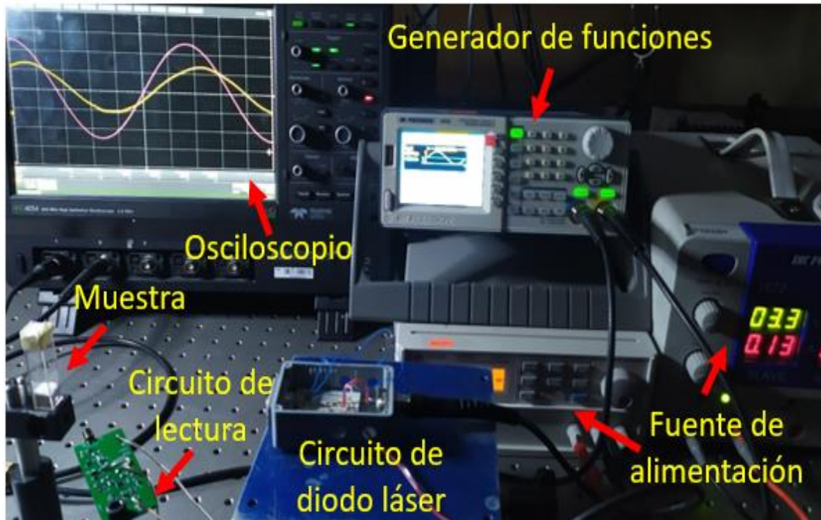
Figura 40. Fotografía de montaje completo realizado para mediciones.
