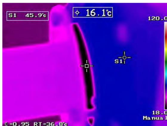
**Figura 5.11:** Máxima diferencia de temperatura alcanzada por el peltier TEC1- 07103T12, en funcionamiento conjunto con el LD NUBM08.
