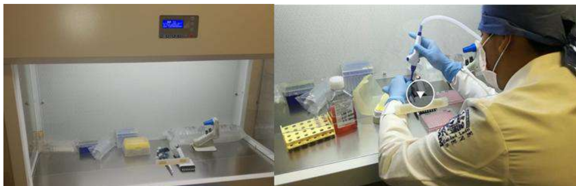
Figura 7.2. Campana flujo laminar y fotografía del llenado de los pocillos con la solución de prueba (muestra+suerofetal bovino + medio DMEM).
