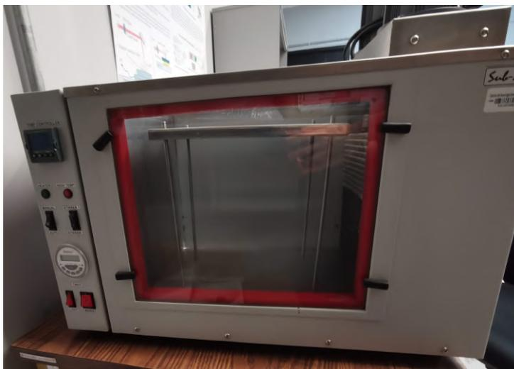
**Figura 3.1:** Baño térmico utilizado para el crecimiento de cristales por evaporación lenta.
