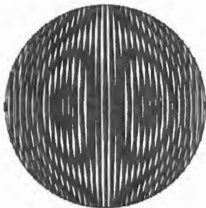
Figura 3.9.- Patrón de Moiré de la aberración de esfericidad del colimador.
