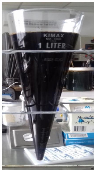
Figura 34: Cuantificación de sólidos sedimentables totales
