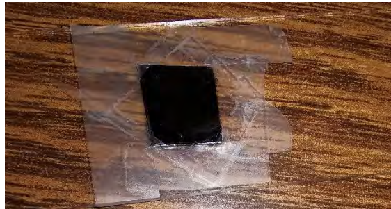
Figura 18.- Sustrato montado en portaobjetos.
