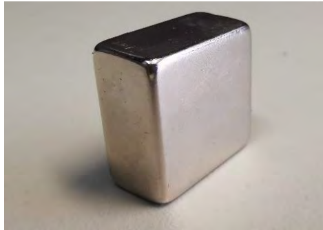
Figura 21.- Imán de neodimio usado en el sustrato.
