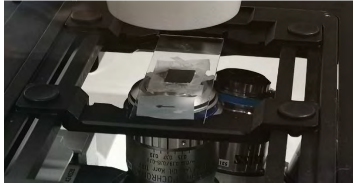
Figura 19.- Muestra colocada en la platina del microscopio confocal.
