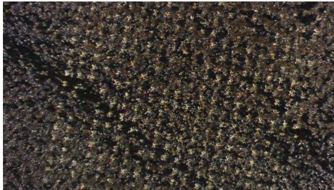
Figura 13.- Nanoantenas con nanopartículas dispersas en fluido de inmersión, observadas con un objetivo 100x en un microscopio común.
