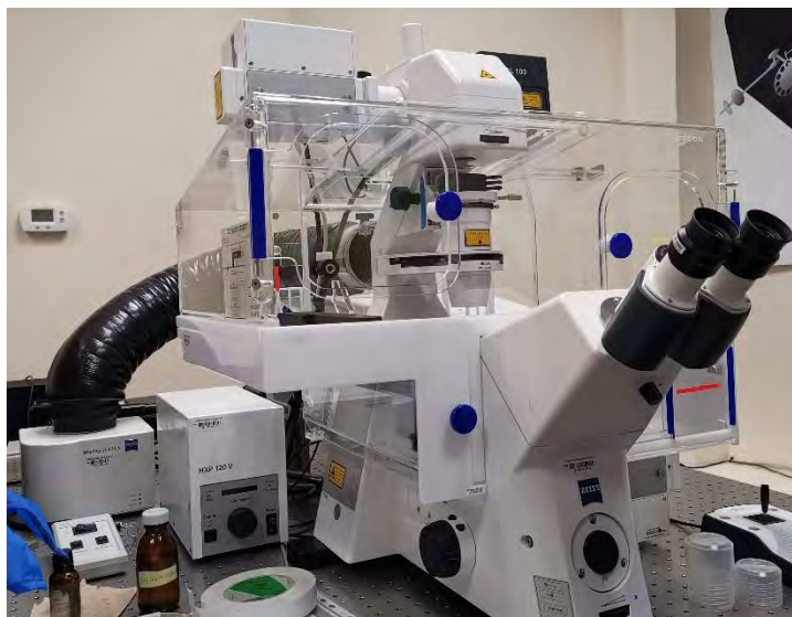
Figura 10.- Microscopio confocal Carl Zeiss LSM 710 NLO.
