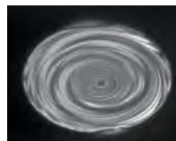
Figura 2.15 Fibra Especial Multimodo(205 \mu m ).
