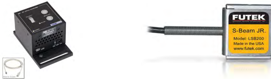
Figura 22. Componentes principales de la máquina de ensayos utilizada. a) Montura de desplazamiento lineal b) Controlador de servomotor c) Celda de carga
