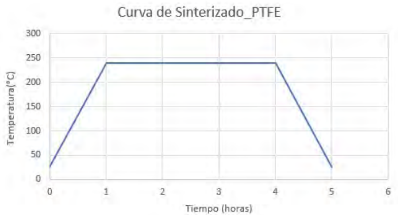
Figura 3.15: Curva de sinterizado de las pastillas de PTFE.
