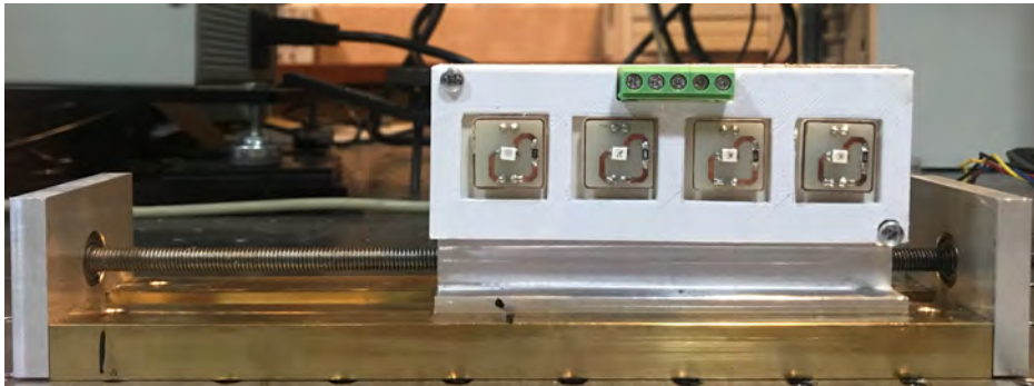
Figura 3.10: Módulo mecánico y de iluminación empotrados.
