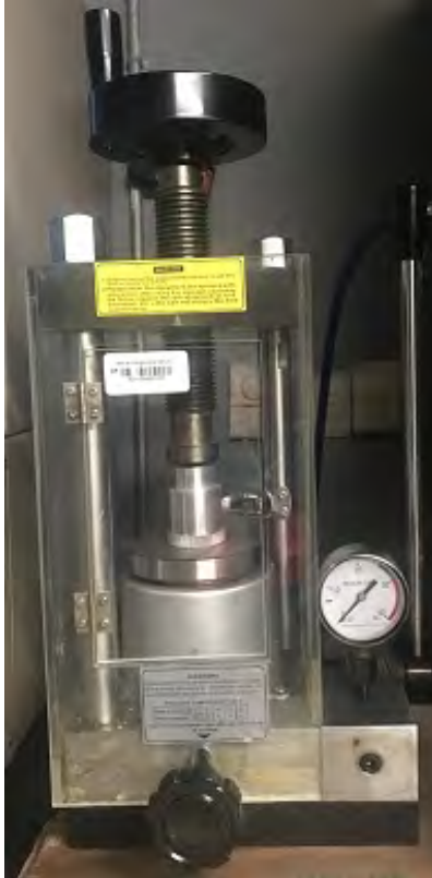
Figura 3.14: Prensado de las muestras a bajas presiones.
