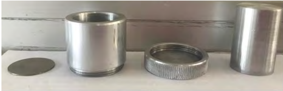
(a) Piezas que conforman el troquel para la fabricación de referencias.
