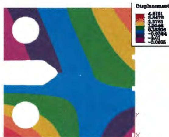
Figura 7.22 Magnitud del desplazamiento fuera de plano placa 3.9mm de espesor
