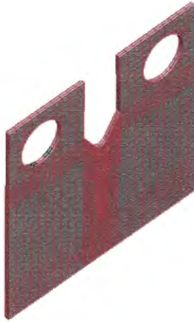
Figura 7.9 Modelo sólido de placa de 1.9mm de espesor con fractura
