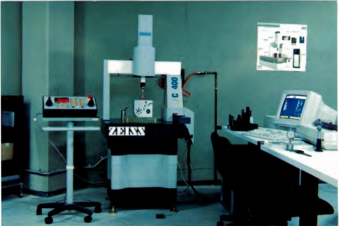
Fig.1.3 Máquina de medición por coordenadas C 400.
