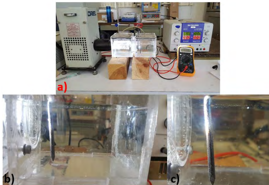
Figura 4.30. Arreglo experimental y proceso de síntesis de hidrógeno utilizando un fotoánodo dopado con 0.5% de Eu, a) inicio del proceso síntesis, b) los primeros 20 minutos de síntesis, c) generación de burbujas en el cátodo después de 60 minutos.
