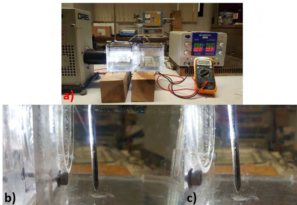
Figura 4.24. Arreglo experimental y proceso de síntesis de hidrógeno utilizando fotoánodo de \text{BaZrO}_3 sin dopar, a) inicio del experimento de síntesis, b) los primeros 20 minutos de síntesis, c) generación de burbujas en el cátodo después de 60 minutos.
