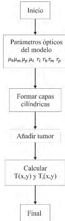
Fig. 34 Diagrama de flujo para obtener la función de transmisión del modelo del dedo con y sin tumor.
