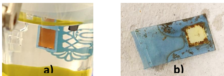
Figura 3.5. a) Electrodo de PET sumergido en electrolito de sulfito de sodio, b) Electrodo de PET después de realizar pruebas electroquímicas
